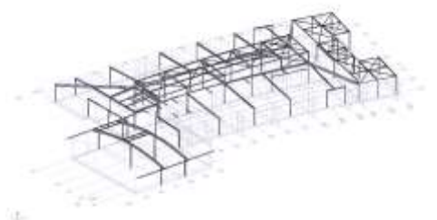
Overzicht staalconstructie deel bouwdeel 1 – bestaande situatie
